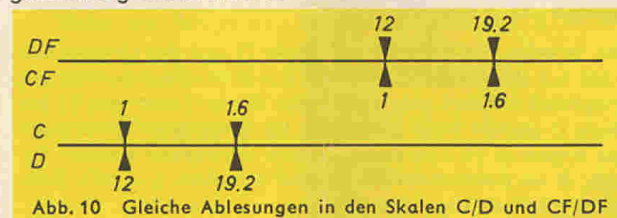
Abb. 10 Gleiche Ablesungen in den Skalen C/D und CF/DF
