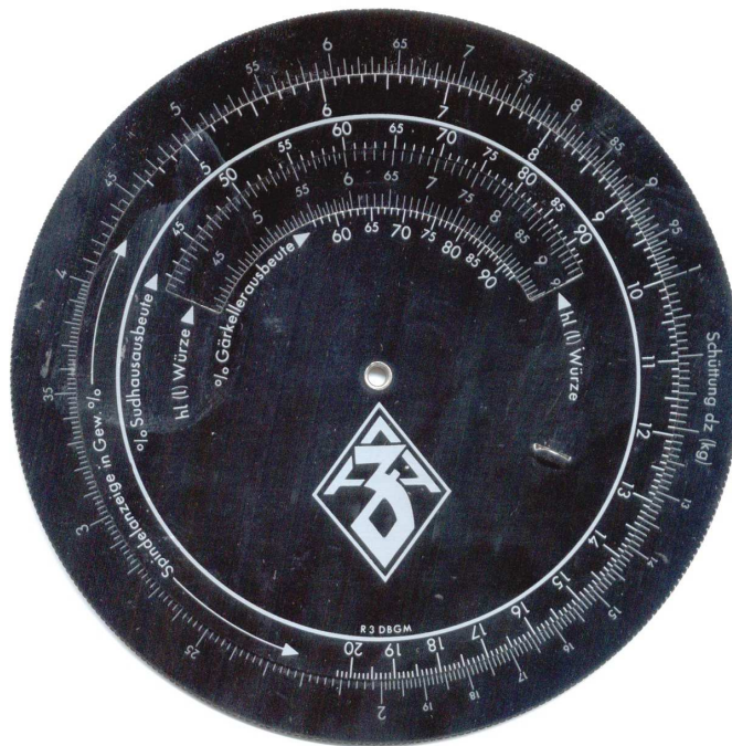
Abb. 13: Rückseite der Brauerei-Spezialrechenscheibe R3 von Rieger
