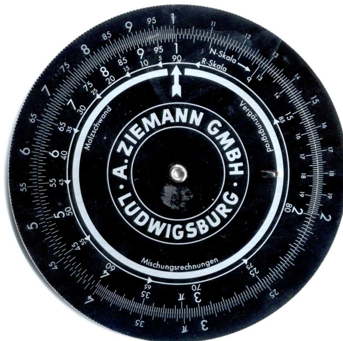
Abb. 12: Vorderseite der Brauerei-Spezialrechenscheibe R3 von Rieger
