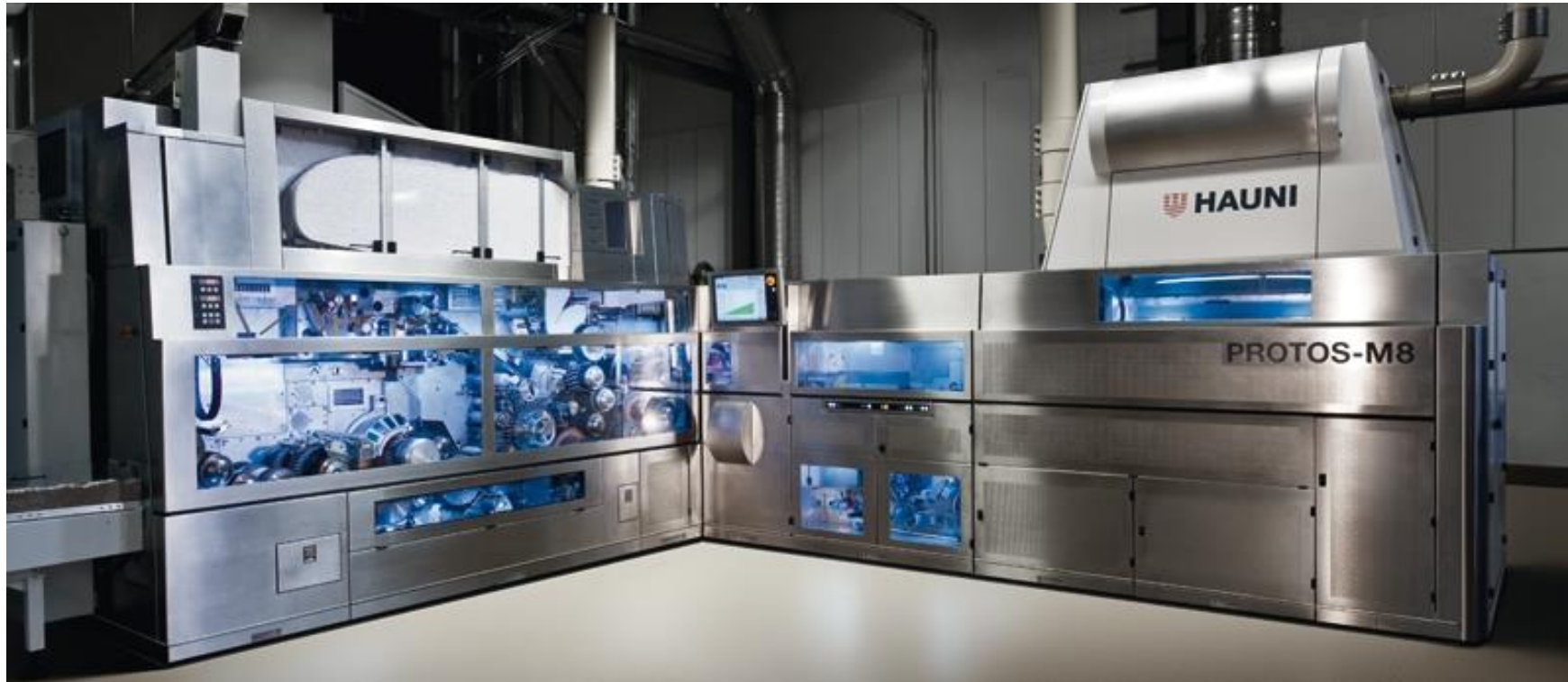
Zigarettenmaschine PROTOS-M8 in einer Schicht 9,37 Millionen Zigaretten
