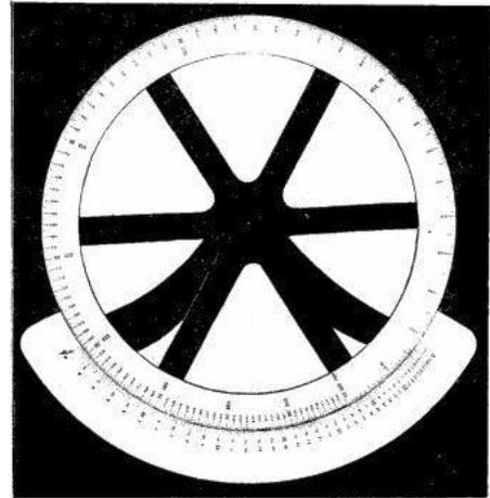
Abb. 123. Patent-Kreisrechenchieber zur optischen Distanz- und Höhenmessung.
