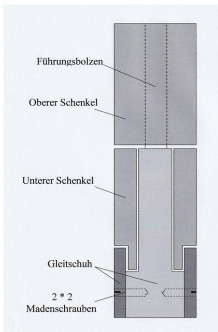
**Schematischer Aufbau des Gleitschuhes**
