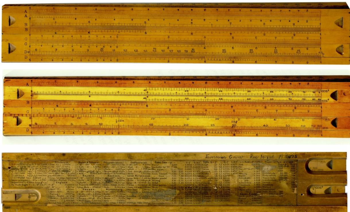
Vorder- und Rückseite des Rechenschiebers aus dem Dennert-Archiv, mittleres Bild mit umgedrehten Zungen
