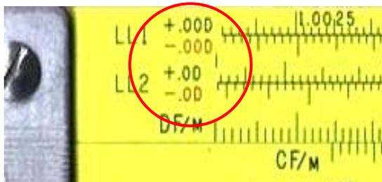
Auf der rechten Seite der LL-Skalen stehen die Korrekturfaktoren für die auf DF/M (rechts der 1) abgelesenen vollständigen Logarithmen.
