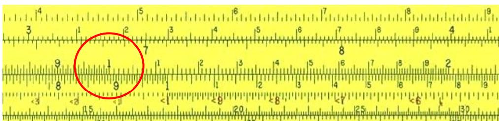
Für die **dekadischen Logarithmen** lg wird der Numeri eingestellt auf LL und lg wird abgelesen auf D und zwar **vollständig und absolut inklusive Kennziffer, korrigiert um den Faktor der entsprechenden LL – Skala.**
