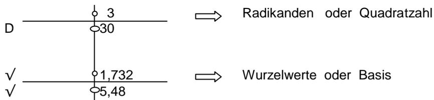
Die drei Kubikskalen sind auf zwei Längslinien angeordnet (1 bis ~ 2,15; ~ 2,15 bis 4,64; 4,64 bis 10). Auch hier muss man sich die Skalen zusammengehängt vorstellen, so dass sich eine Gesamtlänge von 75 cm ergibt ! Die Skalen korrespondieren mit der Skala D, die eingestellten Radikanden oder Potenzen sind relativ (0,72 7,2 72 ...).
