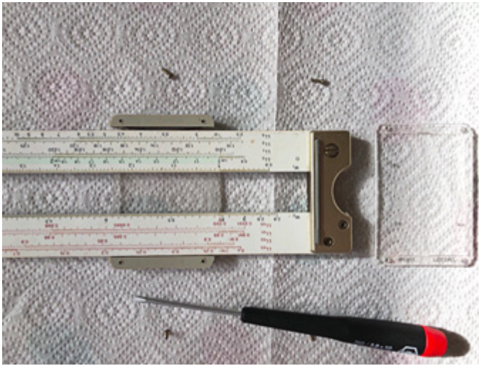
Demontage des Cursors durch Lösen der Verschraubung
