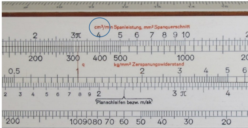
April 1944 CASTELL 1/48 Rechenschieber mit neuem roten Etikett mit korrektem "cm 3 "-Wert oben
